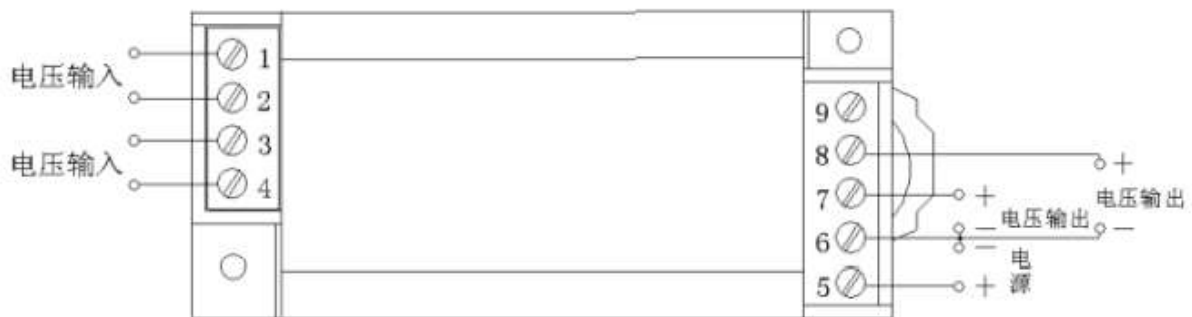
图 2：电压输出产品接线图
