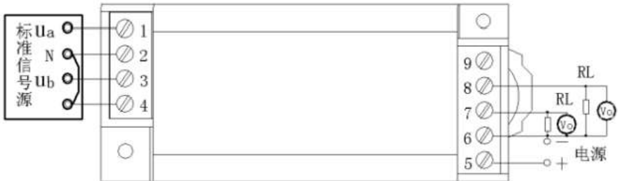
图 5、电压输出产品精度试验接线图
