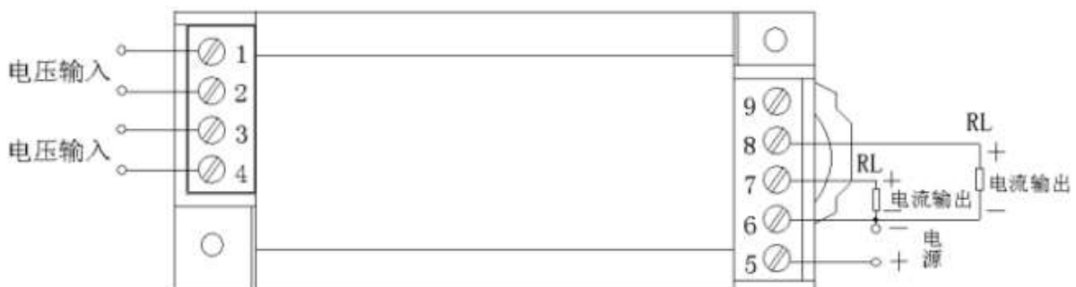
图 2：电压输出产品接线图
