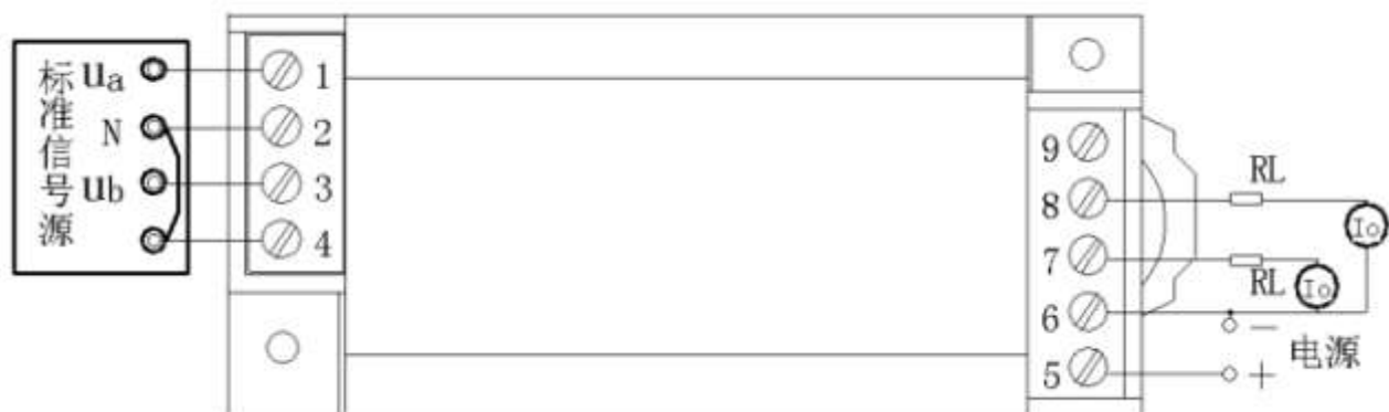
图 6、电流输出产品精度试验接线图
