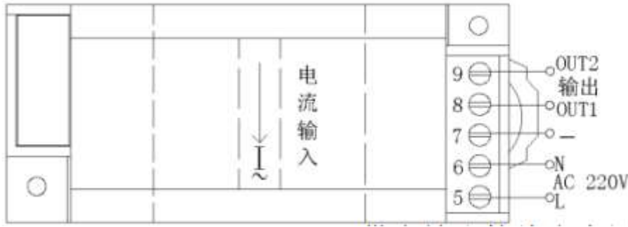
图 4、HY-I07-#9BS3 AC220V 供电输出接线参考图
