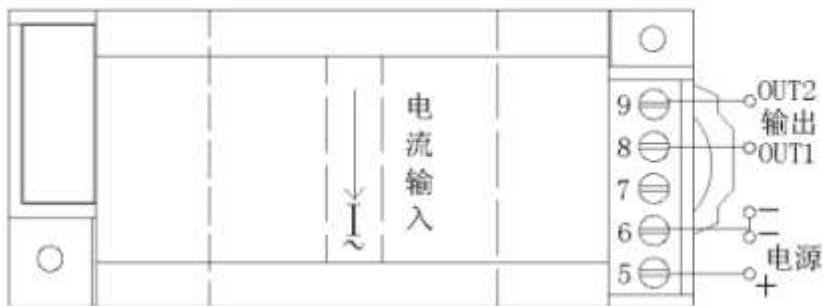
图 2：HY-I07-##BE)S3 直流供电输出接线参考图
