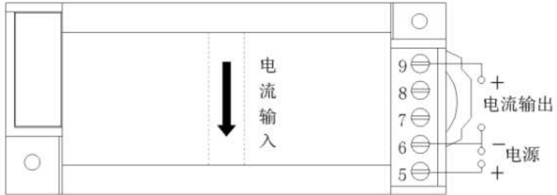
图 2: HY-I03-4*ES3/HY-I03-5*ES3 电流输出产品接线图
